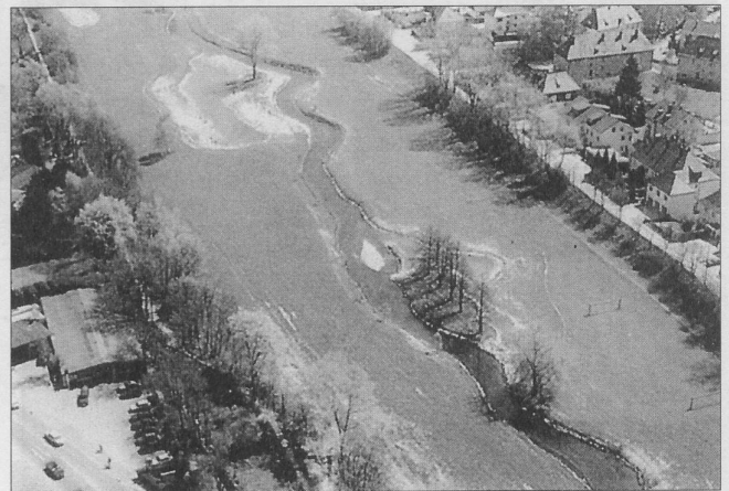
Pfettrach po przebudowie. Dzięki wykonaniu wijących się zakolów powstał urozmaicony bieg strumienia [1].
